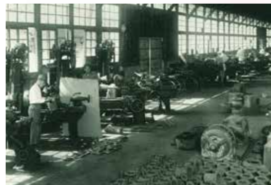
昭和初期の当社鑄鉄工場。ボイラー、バーナー、ラジエーター等を製造していた。手前に見えるのはバーナーの部品。
